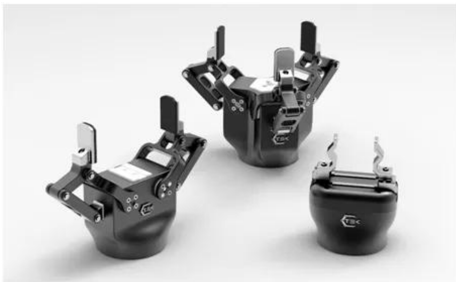
图 | 自适应智能机器人手（来源：知行高科）
