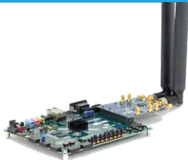
包含 RF 前端和 FPGA 板的典型 SDR 设备
