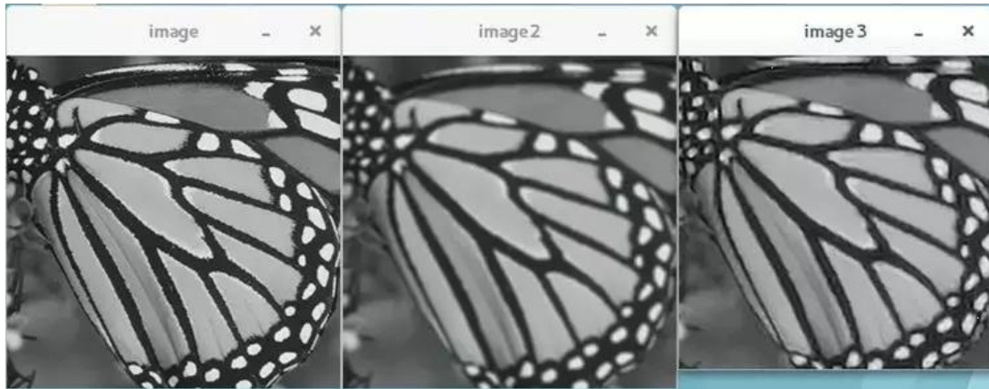
图 2 : 测试经过训练的 FSRCNN。左图为参考标准图像。中间的图像为经过模糊处理与下采样的参考标准图像。右图为使用模型快照进行 300000 次迭代的超高分辨率图像。
