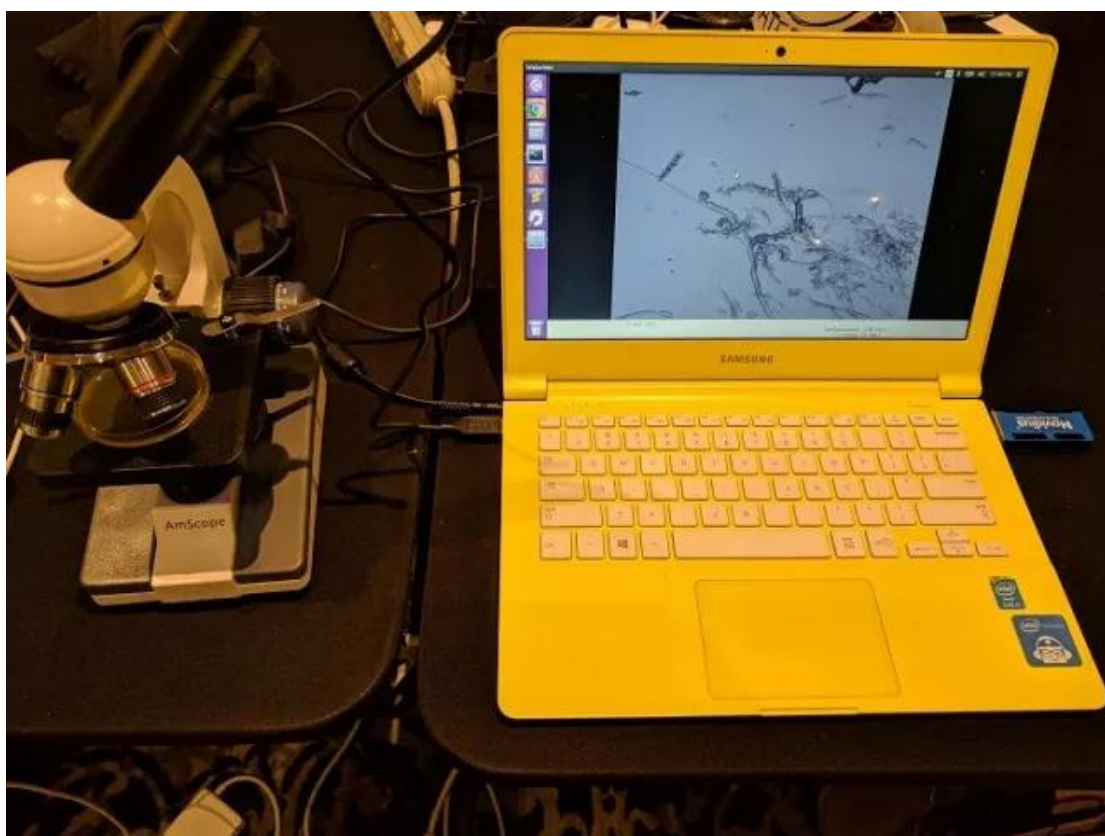
图 3.显微镜、笔记本电脑和计算棒构成的基本测试系统需要不到 500 美元的装配成本。
