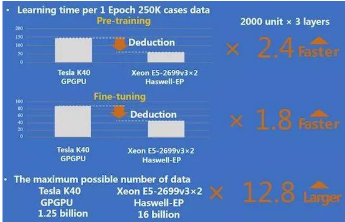
图 1: 与 GPU 相关的 Theano 优化加速和扩大英特尔至强内存容量的影响。
